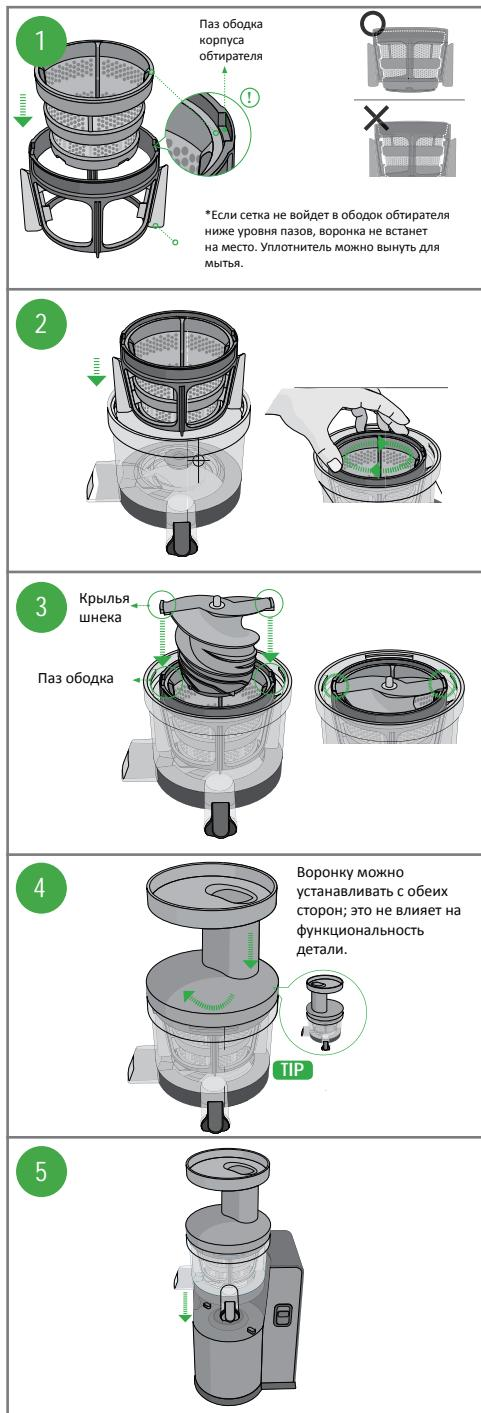
Вставьте сетку в ободок корпуса обтирателя. Сетку необходимо установить так, чтобы ее верхняя часть находилась ниже пазов на ободке, как показано на рисунке 1. В противном случае детали внутри отжимной корзины будут установлены неправильно!
