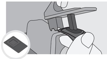
Откройте клапан, придерживайте его с одной стороны и снимите силиконовую крышку с другой стороны, чтобы разобрать.
