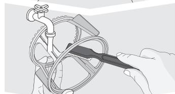
**2** При помощи чистящей щётки промойте внутри и снаружи корпуса обтираетеля проточной водой.
