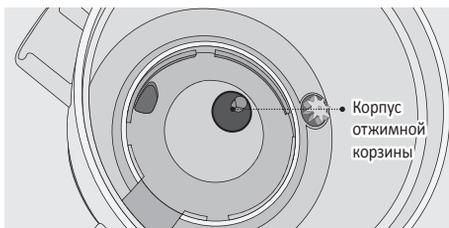
Нельзя разбирать корпус отжимной корзины. Пренебрежение может привести к неисправности прибора.
