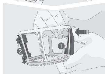
**3** Вставьте внутреннее крыло обтираетеля достаточно плотно, **1** нажимайте на силиконовую щётку от внешней стороны корпуса обтираетеля и потяните внутреннее крыло внутрь корпуса обтираетеля другой рукой, как показано на схеме. Тяните силиконовый обтираетель до упора. При эксплуатации не полностью собранного изделия существует риск поломки. **2** Проверьте, чтобы внешнее крыло было плотно прижато по всей длине к внешней стороне корпуса обтираетеля.
